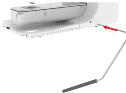
1. Den Kniehebel bis zum Anschlag in den Kniehebelanschluss stecken.
