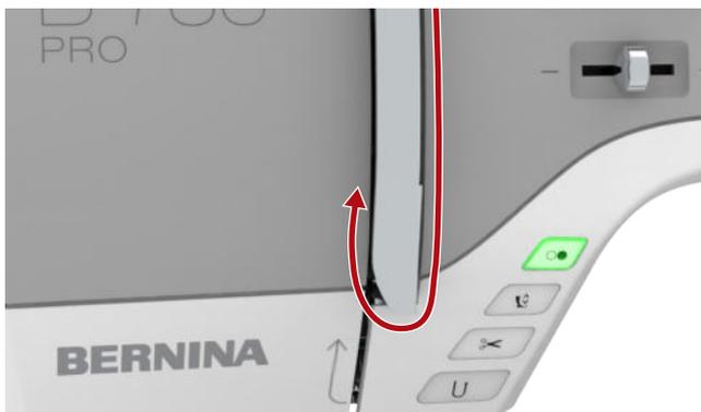
12. Faden durch den Fadengeber ziehen und nach unten führen. Dabei sicherstellen, dass der Faden unter die linke Seitenblende geführt wird.
